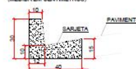
DETALHE DA GUIA EXTRUSADA (MEDIDA EM CENTÍMETROS)
