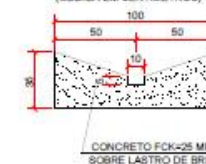
DETALHE DO SARJETÃO (MEDIDA EM CENTÍMETROS)
