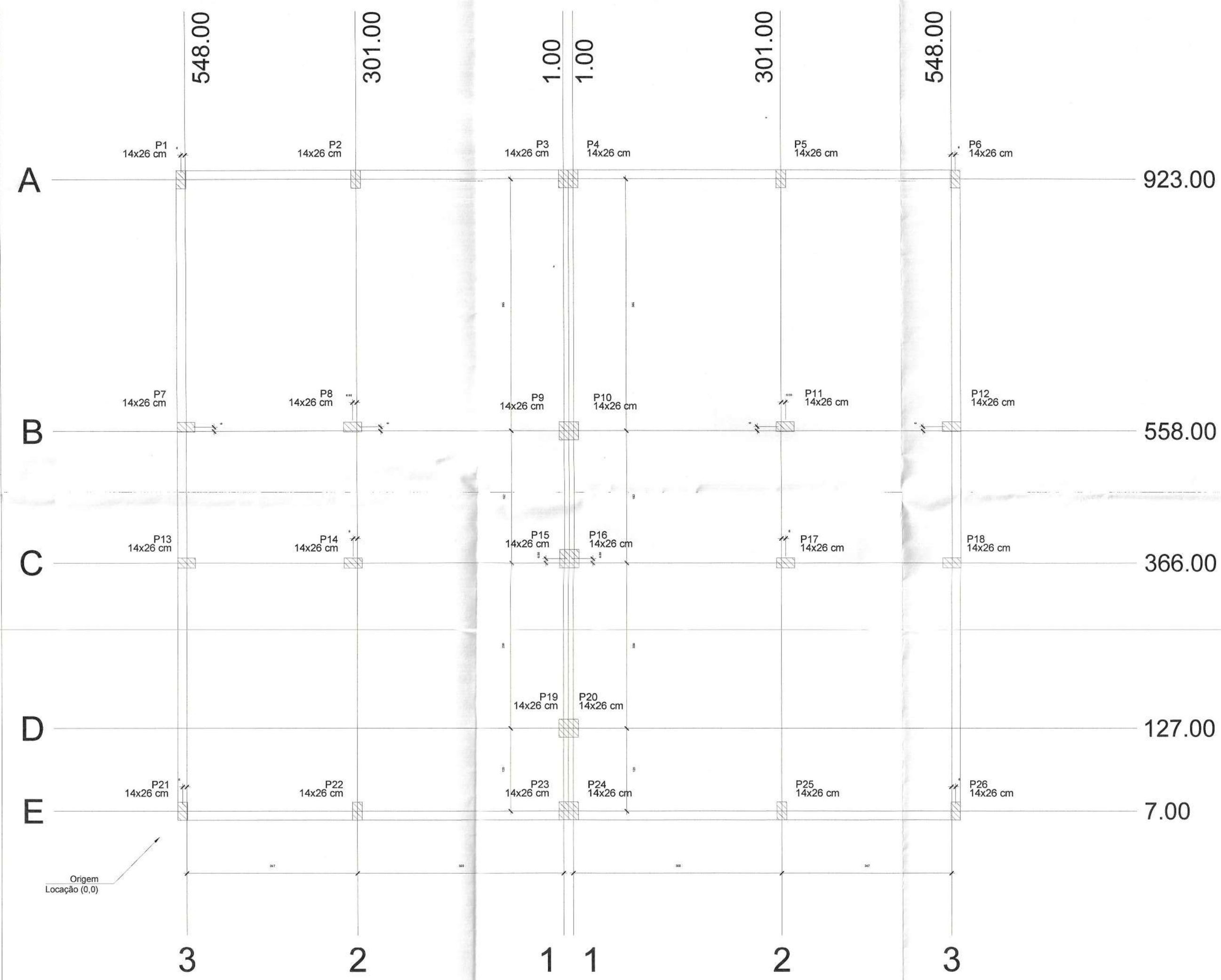
Planta de locação escala 1:50
