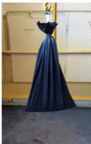
Figura 5. Ensaio de Verificação da Estanqueidade.
